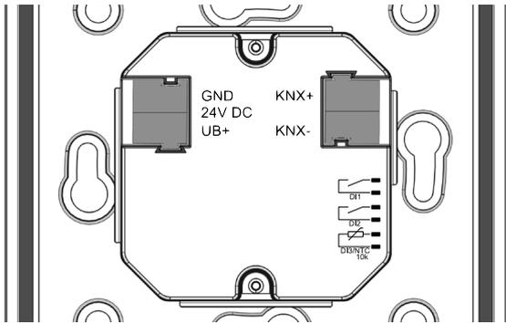
Seitlich im Gehäuseunterteil befindet sich eine Buchsenleiste zum Anschluss von bis zu 3 digitalen Eingängen (davon alternativ ein Temperatursensor NTC10k) Der Anschluss wird über einen vorkonfektionierten Buchsenstecker (im Lieferumfang enthalten).
