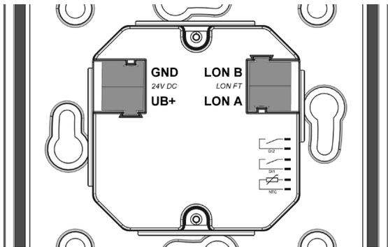
Seitlich im Gehäuseunterteil befindet sich eine Buchsenleiste zum Anschluss von bis zu 2 digitalen Eingängen und einem NTC10k. Der Anschluss wird über einen vorkonfigurierten Buchsenstecker (im Lieferumfang enthalten).
