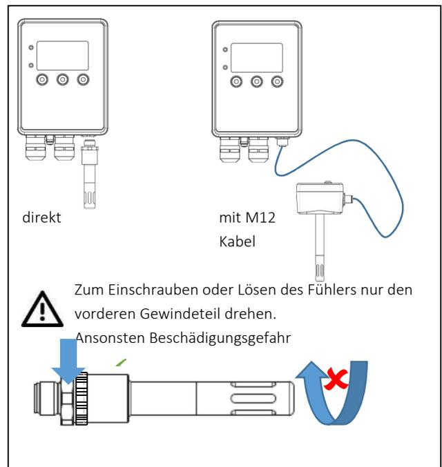
Montage eines fixen Messfühlers:
