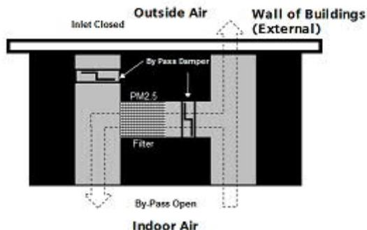
Ist die Bypass-Klappe aktiv via Regeleingang am Master, ist die Zufuhr durch den Master gesperrt und es tritt keine Aussenluft ein. Als Folge wird alle Fortluft (oder teilweise) über den Bypass-PM2.5-Filter für eine rauminterne Zirkulation in den Raum gezwungen. Die Ventilatorstufen werden gemäss PM2.5-Istwert und PM2.5-Sollwert geschaltet.
