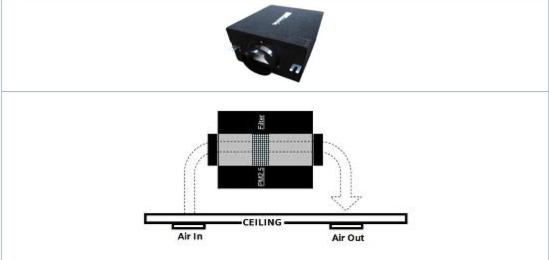
Der RDF870... kann als PM2.5-Regler mit externem PM2.5-Fühler an X1 eingerichtet werden, um den Ventilator eines PM2.5-Reinigungsgeräts zu regeln (d.h. Einzelkanal, 1-stufiger Lüftungsreiniger mit eingebautem PM2.5-Filter).
